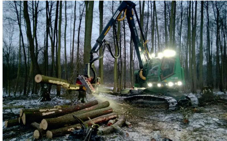
Cosechadoras con cabezal procesador para tala y desrame para trabajo en pendientes hasta 70%. Cortesía Neuson Forest GmbH
