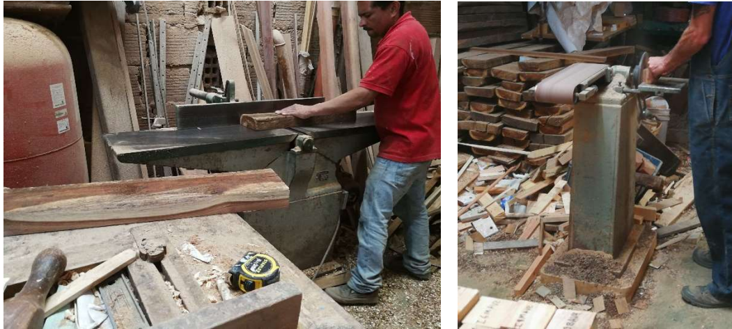
Figura 3-8 Elaboración de probetas en carpintería externa
