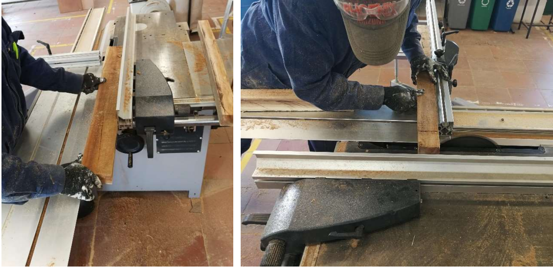
Figura 3-6 Elaboración de probetas en la carpintería de la facultad de ingeniería
