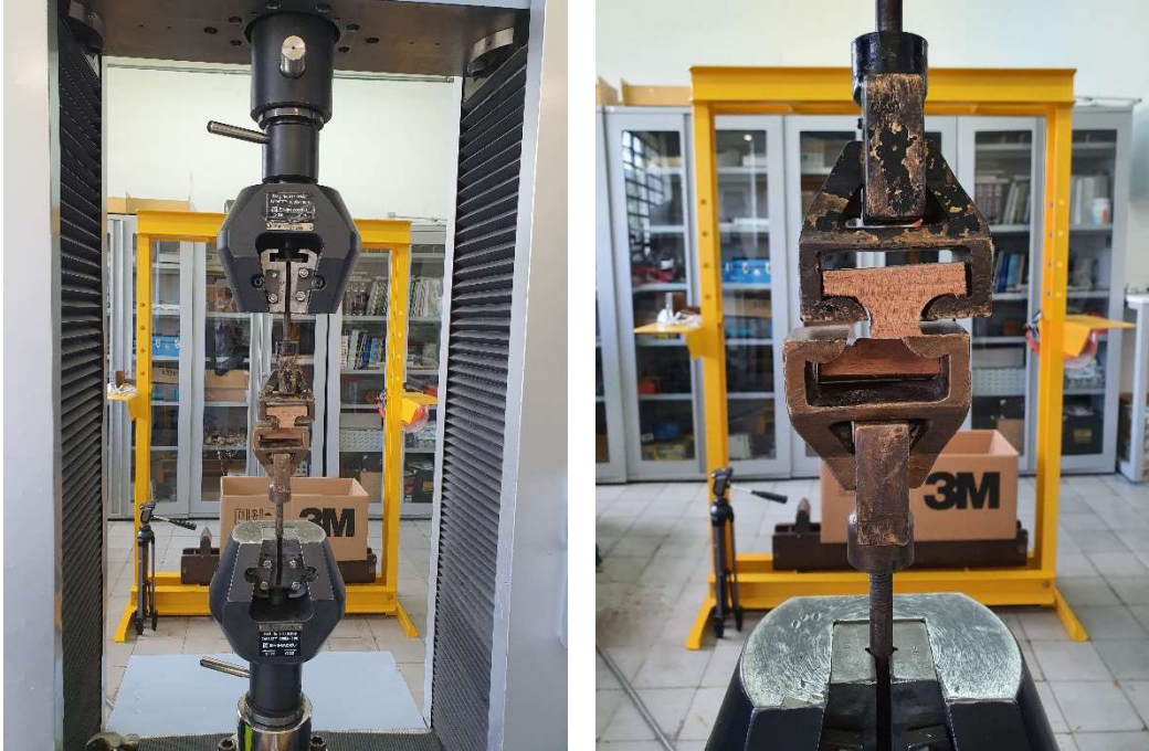
Figura 3-14 Ensayo resistencia a la tracción perpendicular
