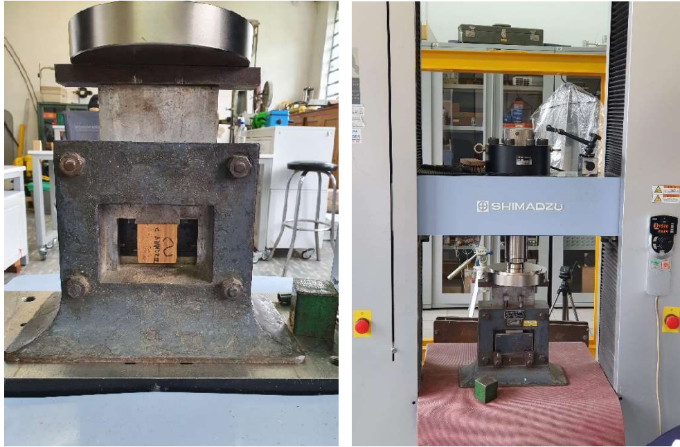
Figura 3-15 Ensayo resistencia a cortante paralelo al grano
