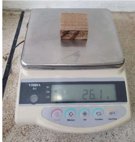
Figura 3-16 Determinación del peso para contenido de humedad
