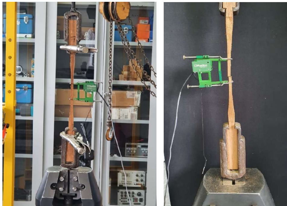
Figura 3-13 Ensayo resistencia a la tracción paralela al grano
