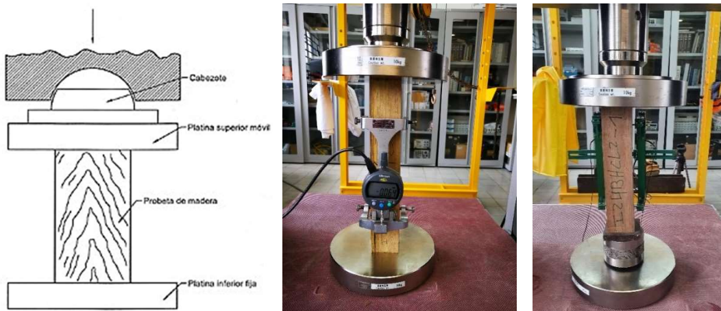
Figura 3-10 Esquema y ensayo en laboratorio resistencia a compresión paralela Fuente esquema: NTC 784
