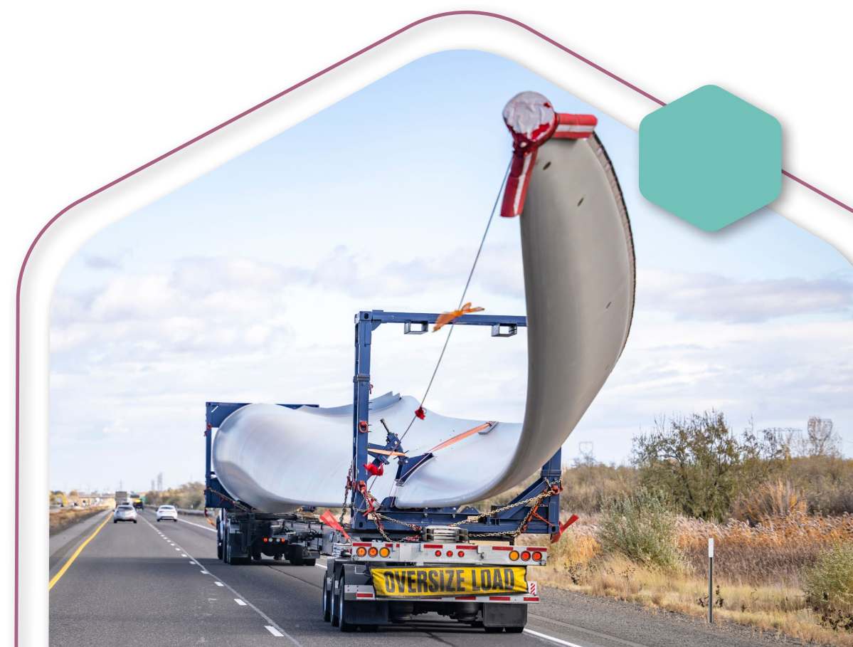
Foto: Camión con transporte adicional de carro sobrecarga una hoja larga de una turbina eólica / Vitpho
