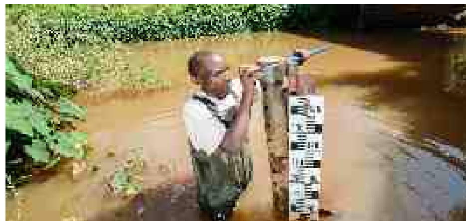
Figura 7. Personal de la Autoridad de Gestión de Recursos Hídricos de Kenya (WRMA) instala soportes para medidores fluviales en el río Tana © CIAT/Georgina Smith
