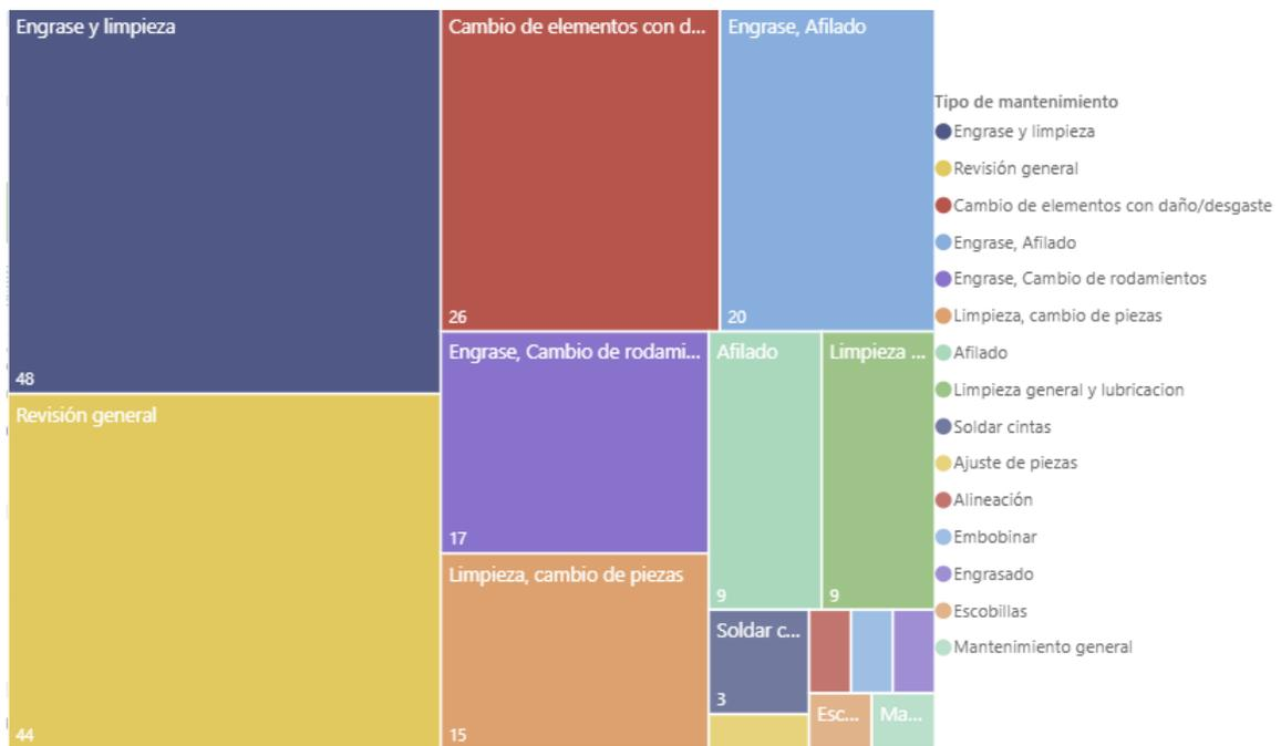
Figura 33. Actividades de mantenimiento realizado por los centros de transformación y comercialización de madera a su maquinaria, en el departamento de Cundinamarca
