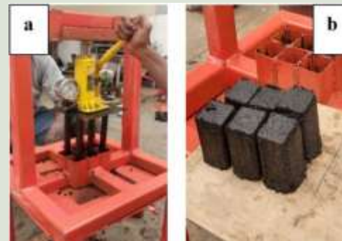
Figure: Proceso de moldeado de briquetas (a) y briquetas tras el moldeado (b)
